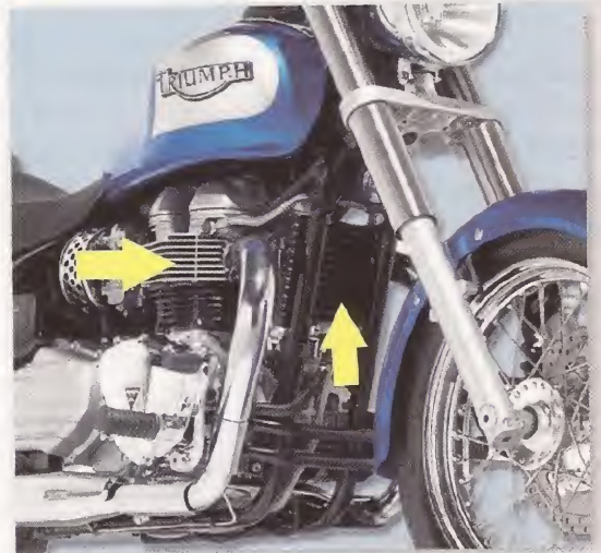
Refrigeración por aire directo y líquido
